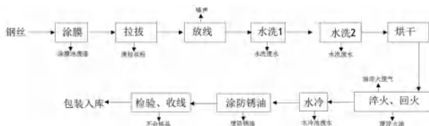
图 2.2-9 8号磷化生产线工艺流程及产污环节图
